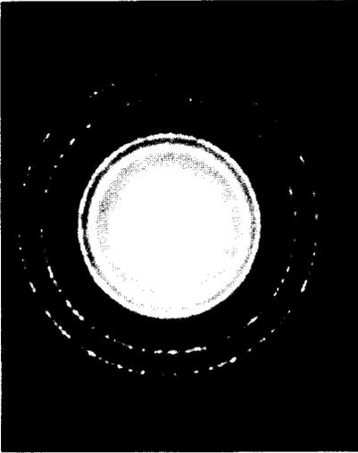
**Figura 6.4** Patrón de difracción electrónica para una muestra policristalina de cloruro de telurio. (Cortesía de A. J. Ardell, trabajo de investigación no publicado.)
