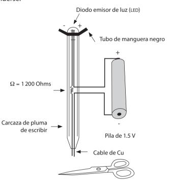
Figura 1. Conductividad eléctrica. Entre todos los elementos del aparato, la parte más cara es la pila.
